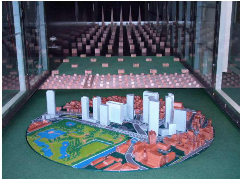
Figuur 4: Windtunnelsimulatie: de luchtstroom komt van achter de driehoekige elementen. Deze elementen en de blokjes op de tunnelvloer veroorzaken het gewenste profiel van de windsnelheid als functie van de hoogte. De maquette (vooraan in de foto) bevindt zich op een draaibare schijf waarmee de windrichting wordt bepaald. De verticale doorsnede van de tunnel is 2,6 \times 2,4 \text{ m}^2 . (Bron: Shimizu Corporation, Japan.)
